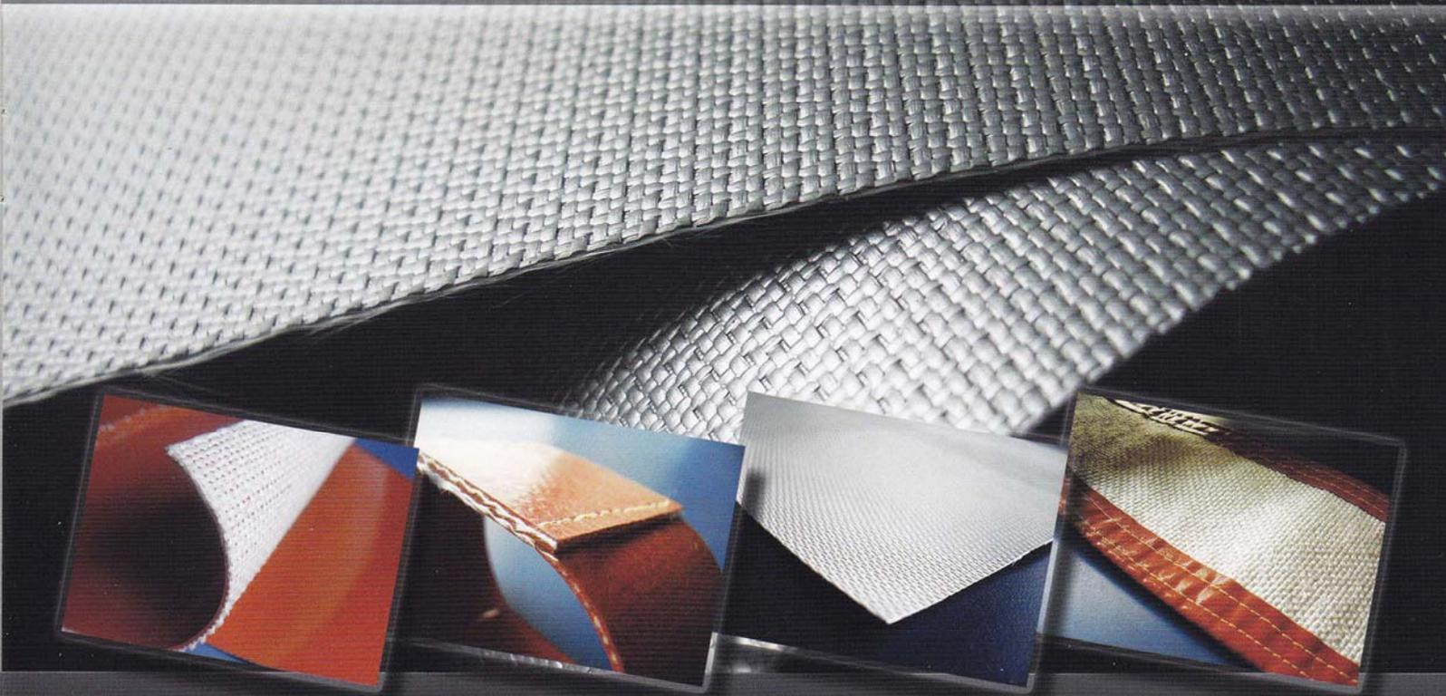
Son telas finas fabricados con filamentos en continuo de fibra de vidrio "E" recubiertos con caucho de silicona de alta resistencia térmica (260-280°C). Este recubrimiento los convierte en tejidos muy fuertes mecánicamente, sobretodo en abrasión, rozamiento y desgarró. Además les proporciona una excelente impermeabilidad pudiéndose utilizar en intemperie, agua, vapor, humos y gases de combustión. Tienen gran flexibilidad que les proporciona facilidad para confeccionar y coser. Se puede limpiar.
