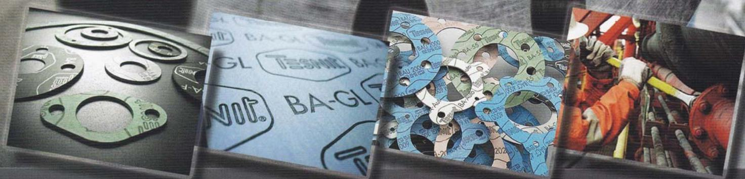
**Tesnit®** son planchas fabricadas a base de fibras comprimidas y aglomeradas con caucho sintético. La función de estas planchas es de junta de estanqueidad, generalmente en bridas para evitar fugas de fluidos, como el agua, vapor, gases, aceites, fuels, ácidos y álcalis, freones, alcoholes, disolventes, etc. en condiciones de trabajo a cargas bajas y altas, temperaturas hasta 650°C en seco y 300°C en vapor. Formato estándar de 1500x1500 mm., espesores de 0.5, 0.8, 1, 1.5, 2, 2.5, 3, 4 y 5 mm.
